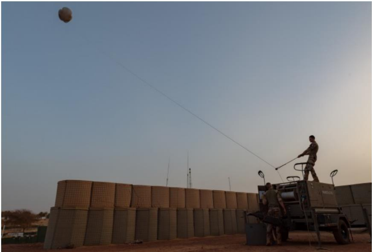
23 Ballon captif avec un terminal radio pour augmenter la portée lors d'une mission Armée de Terre (Source AdT)
