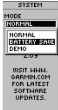
*L'autonomie des piles de l'eTrex est de 22 heures en mode BATTERY SAVE (Economie de pile) avec des piles alcalines.*
