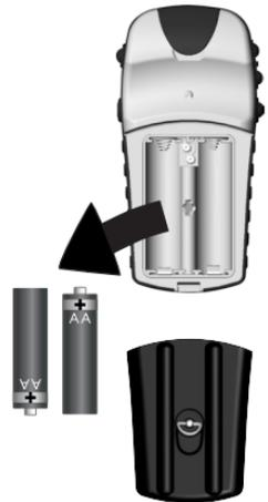
*Retirez les piles de l'eTrex si vous ne pensez pas l'utiliser avant plusieurs mois. Veillez à observer la polarité des piles lors de leur réinstallation. Suivez les instructions du fabricant des piles pour l'entretien et la manipulation de ces dernières.*
