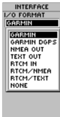
Les options d'interface permettent d'utiliser un PC pour télécharger les waypoints, les routes et les journaux de suivi.
