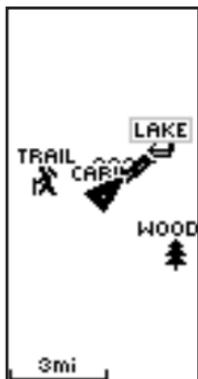
Lorsque vous sélectionnez **Orient Map Northward** (Orienter la carte au nord), l'icône de personnage est remplacée par un triangle de « direction ». La pointe du triangle indique la direction générale dans laquelle vous vous déplacez.
