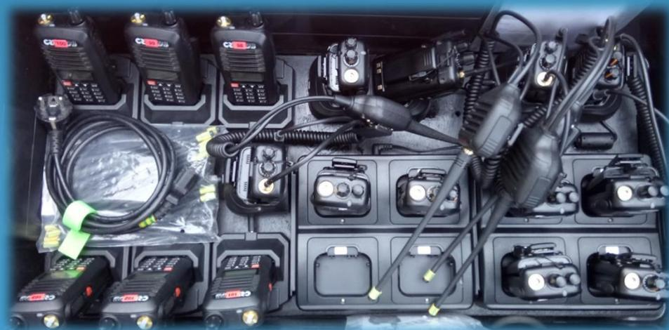
*1 lot d'appui avec 17 portatifs VHF complets en kit individuel, comprenant une réserve de matériels et consommables (6 chargeurs individuels, 25 pack batteries avec pinces, câble de couplage pour caisse, antennes de secours, micro-HP déportés, micro-oreillettes, pièces et outils de maintenance.)*
