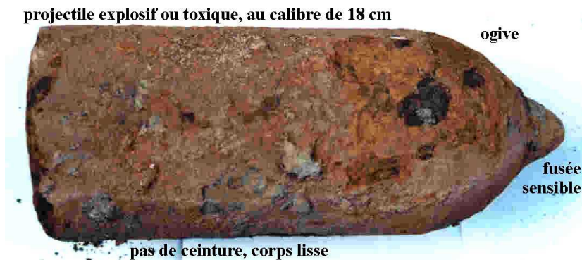
Projectile de 18 cm pour Gaswerfer, chargé en toxique suffocant ou en arsine. A existé en explosif.
