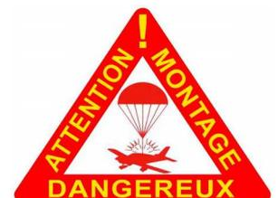
Ce signalement peut être altéré ou disparaître après un impact suivi de feu. A ce titre, ces systèmes restent actifs et instables pendant et après un incendie.
