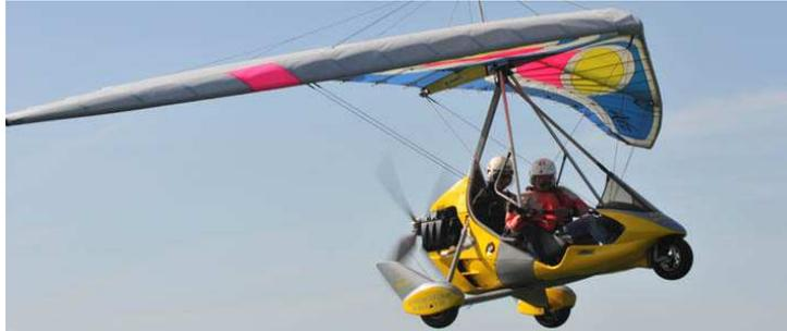
Un pendulaire est un aéronef monomoteur sustenté par une voile souple sous laquelle est généralement accroché un chariot motorisé. Il répond aux conditions techniques suivantes :
